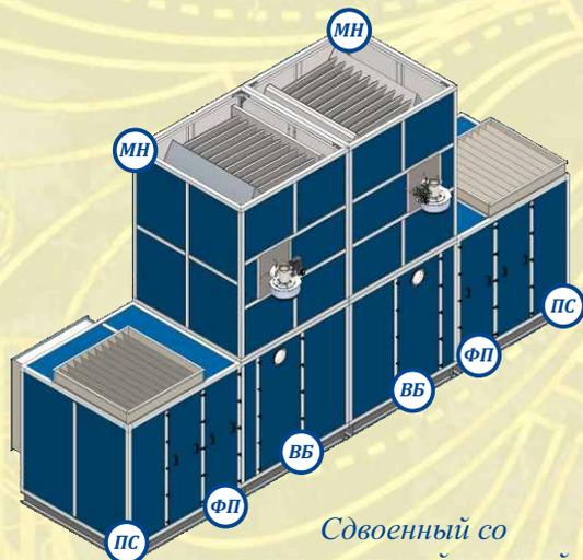
Сдвоенный со смесительной камерой и секцией фильтров
