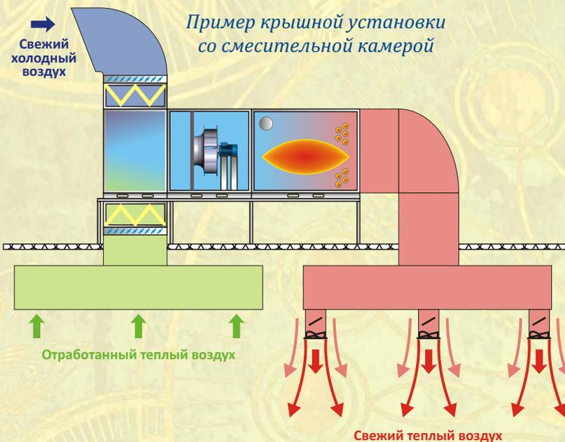
Пример крышной установки со смесительной камерой
