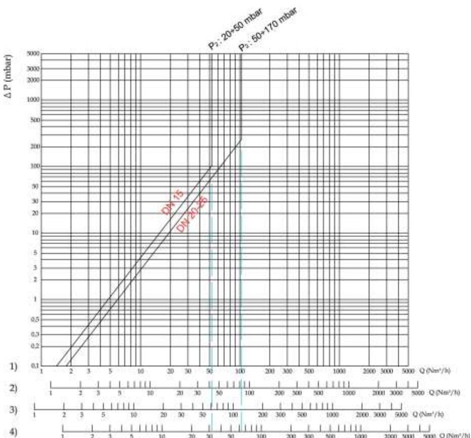
1) метан; 2) воздух; 3) сжиженный газ; 4) сжиженный нефтяной газ
