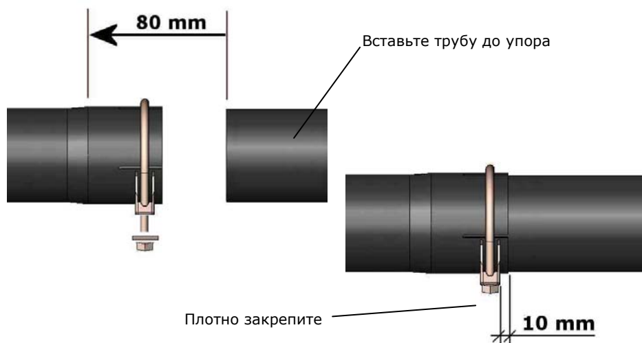
Рисунок 3.13 Сборка и крепление труб (для всех моделей)
