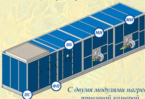
Одинарный "угловой" со смесительной камерой и секцией фильтров
