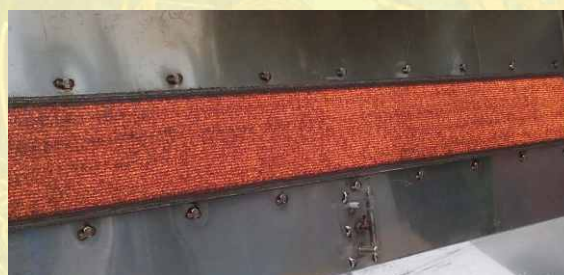
инфракрасная горелка для гидротермического котла 440 кВт (L=1440мм)
